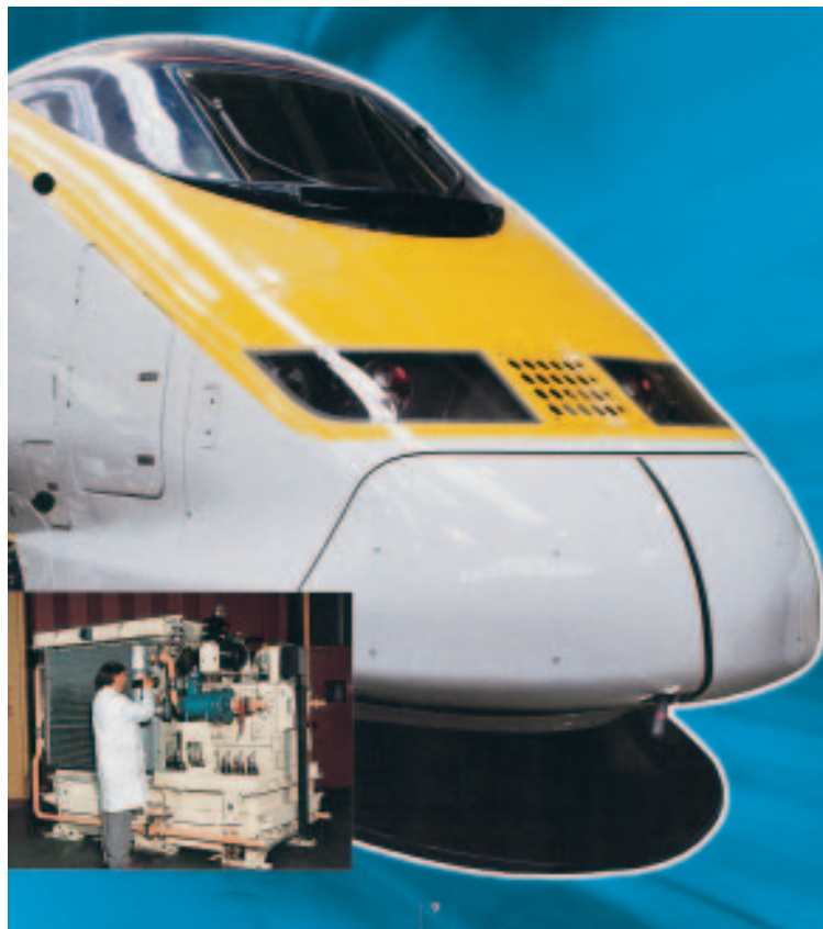
Σχ. 3.28: Η/Ζ με νηξελοκίνητο - 3~εναλλακτήρα για ασύγχρονο ηλεκτροκίνητο τρένο.
